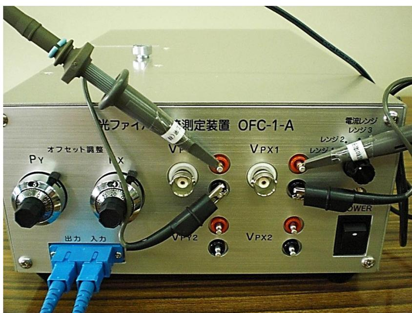
なお、 $V_{px1} \cdot V_{py1}$  出力のBNC接続・プローブ接続の同時接続は対応しておりませんのでご了承ください。
